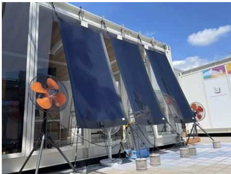
「G7広島サミット2023」会場にて展示された フィルム型ペロブスカイト太陽電池 （出典）積水化学工業株式会社
